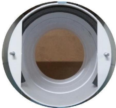
Вставьте трубу в отверстие и обеспечьте небольшой наклон трубы наружу, чтобы конденсированная влага стекала во внешнем направлении. Обеспечьте горизонтальное расположение элементов крепления наружу. Добавленные 10 мм. должны выступать внутри помещения.
